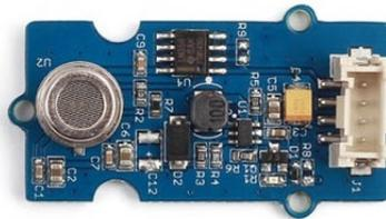
FIGURE 3 – Capteur de qualité de l'air – modèle *MP503*
